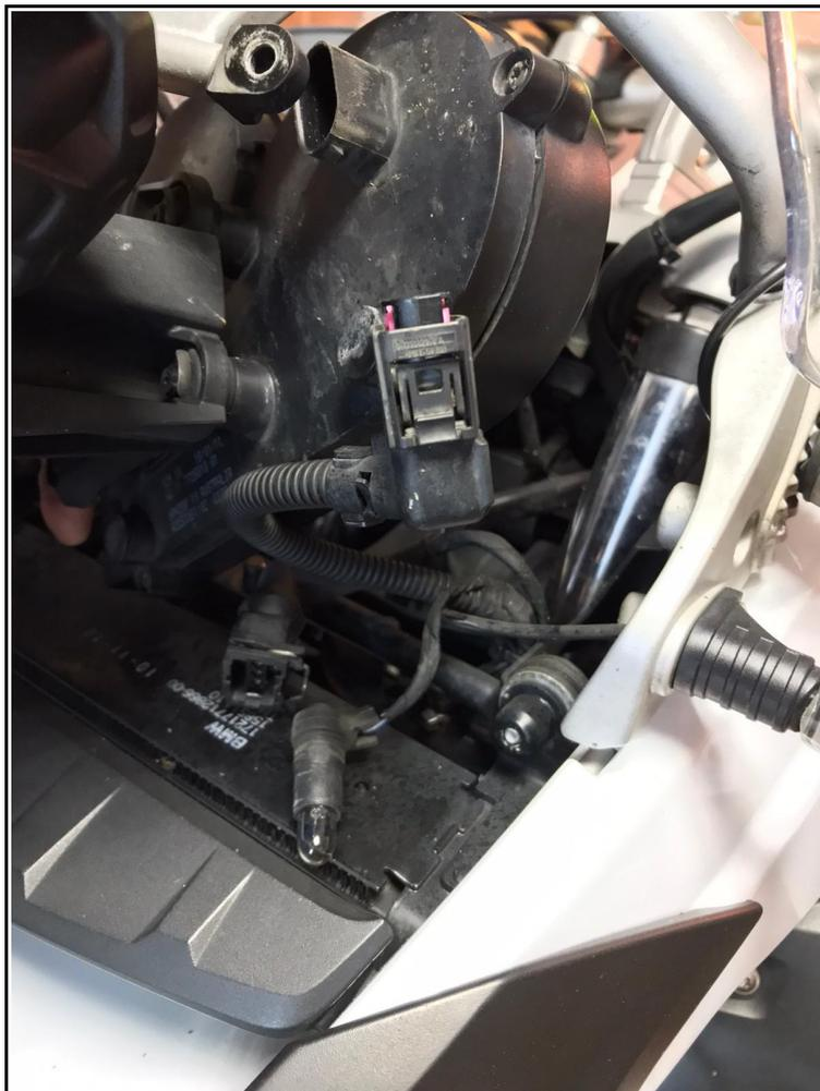
6. Die drei Klammern von der Tachoeinheit lösen und das Tacho abnehmen.
