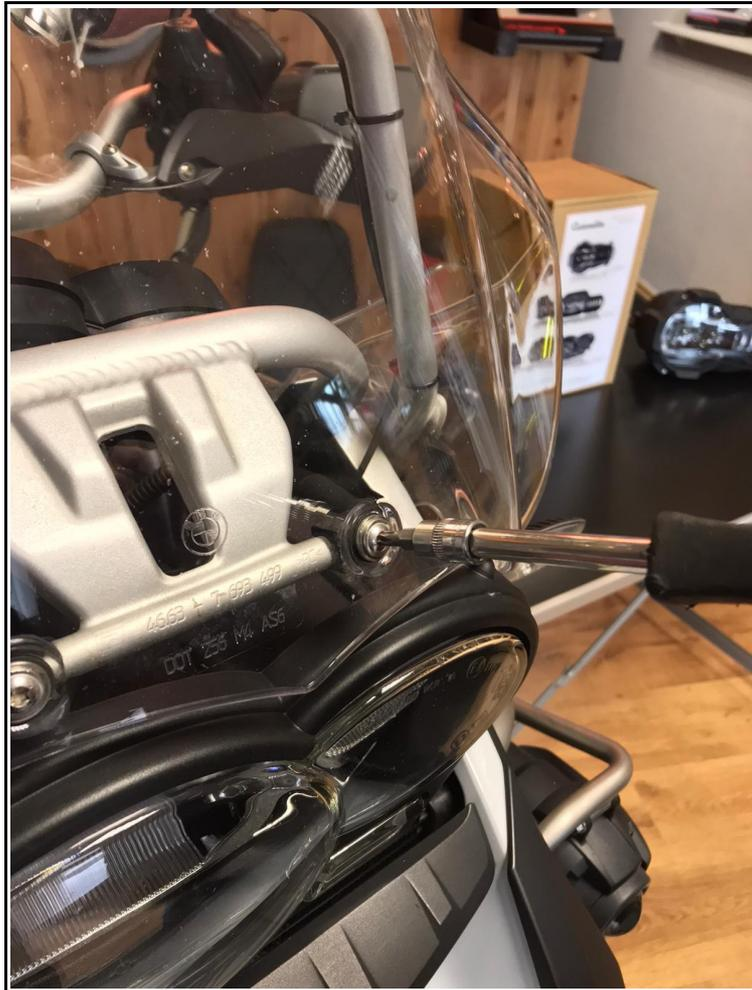
**2. Windschildversteller links und rechts demontieren. Hierzu den Versteller lösen und mit einem 10mm Schlüssel (oder Knarre mit Nuss) gegenhalten. Sobald die Mutter demontiert ist, kann durch weiteres Lösen des Verstellers die innere Zweikant-Mutter gelöst werden**
