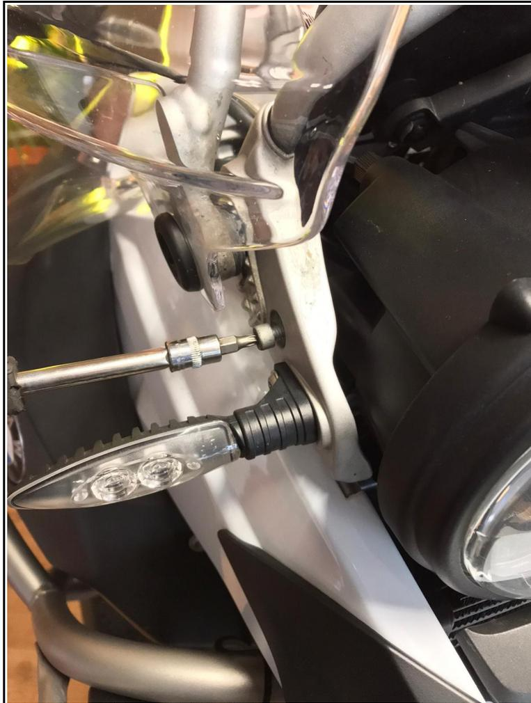
**5. Den Scheinwerfer mit Tacho vorsichtig nach vorne ziehen, die Stecker für Tacho und Scheinwerfer lösen und das Standlicht herausziehen und dann den Scheinwerfer durch die Öffnung entnehmen.**
