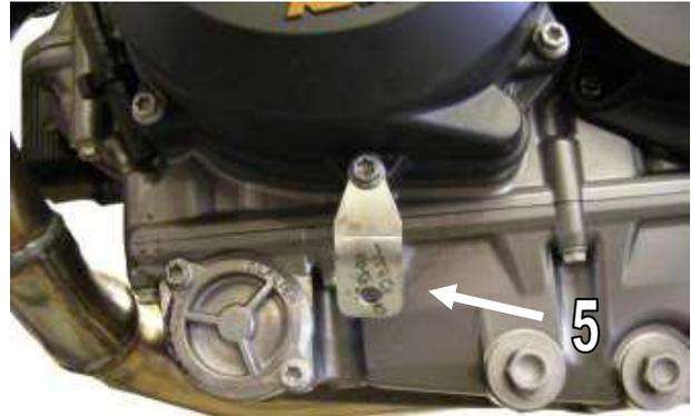
5. Befestigen Sie die rechten Halter am Fahrzeug unter der Verwendung der originalen Schrauben, ziehen Sie diese aber noch nicht fest Abb.5&6 / *Loosely fit the right hand brackets to the bike using the original screws Fig.5&6*
