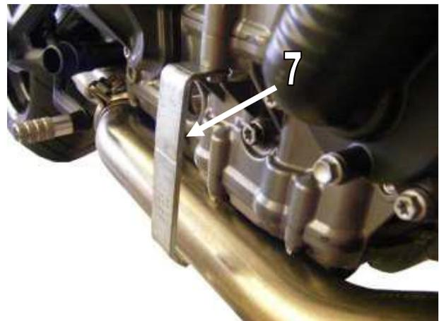
6. Montieren Sie den Bugspoiler an den Haltern mittels der M6x20 Schrauben (11) und der M6 Mutter (10). Sobald der Bugspoiler korrekt ausgerichtet ist, ziehen Sie bitte die Schrauben der Halter fest Abb.7 / *Fit Belly Pan to brackets using M6x20 socket screws (11) and M6 flange nuts (10). Once positioned correctly, fully tighten all brackets. Fig.7*
